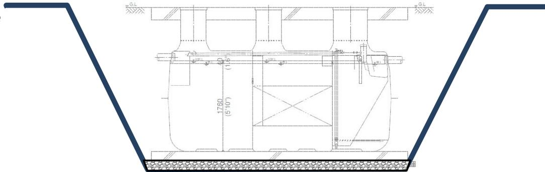
**Step 3: Set pre-cast concrete or pour concrete base.**
